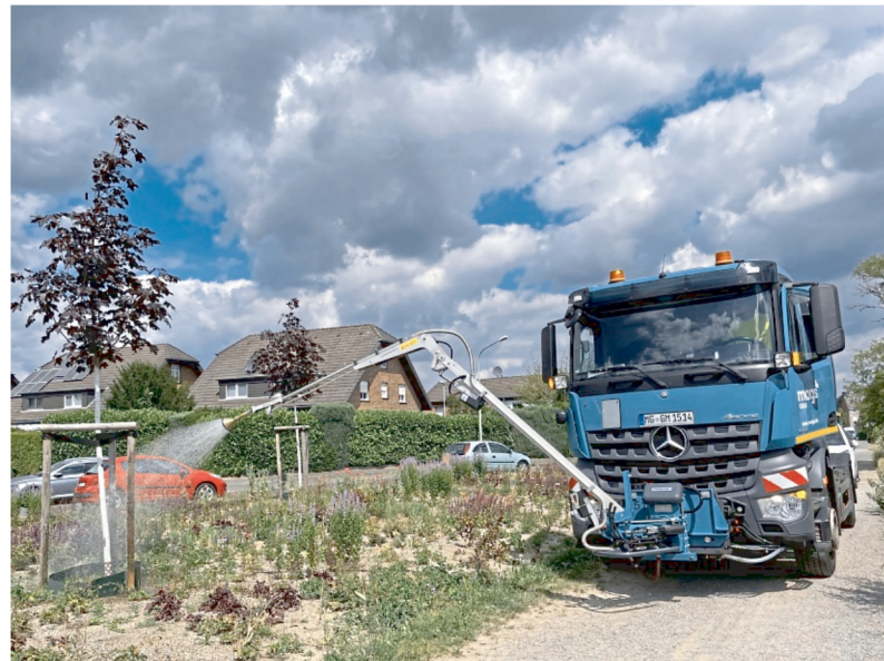
Baumbewässerung mit Hilfe eines Systems von mm-lab: Ein Lkw mit Gießarm auf Gießtour. Foto: mags Mönchengladbacher Abfall-, Grün- und Straßenbetriebe AöR/p
